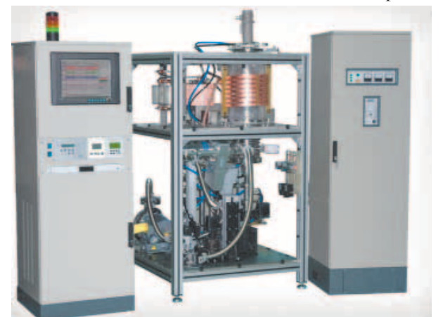
Установка для выращивания монокрибида кремния сублимационным методом
